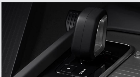
čalúnená hlavica radiacej páky, bez použitia kože
